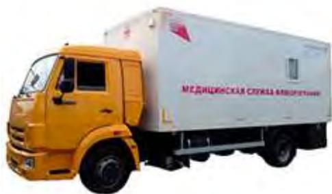
На шасси автомобилей, предназначен для обеспечения рентгенографического обследования населения вне стационара в отдаленных районах, не имеющих больниц и клиник с маммографическими и рентгенографическими кабинетами. Оснащается аппаратом рентгеновским цифровым и маммографом рентгеновским компьютеризированным с ручным и автоматическим управлением.
